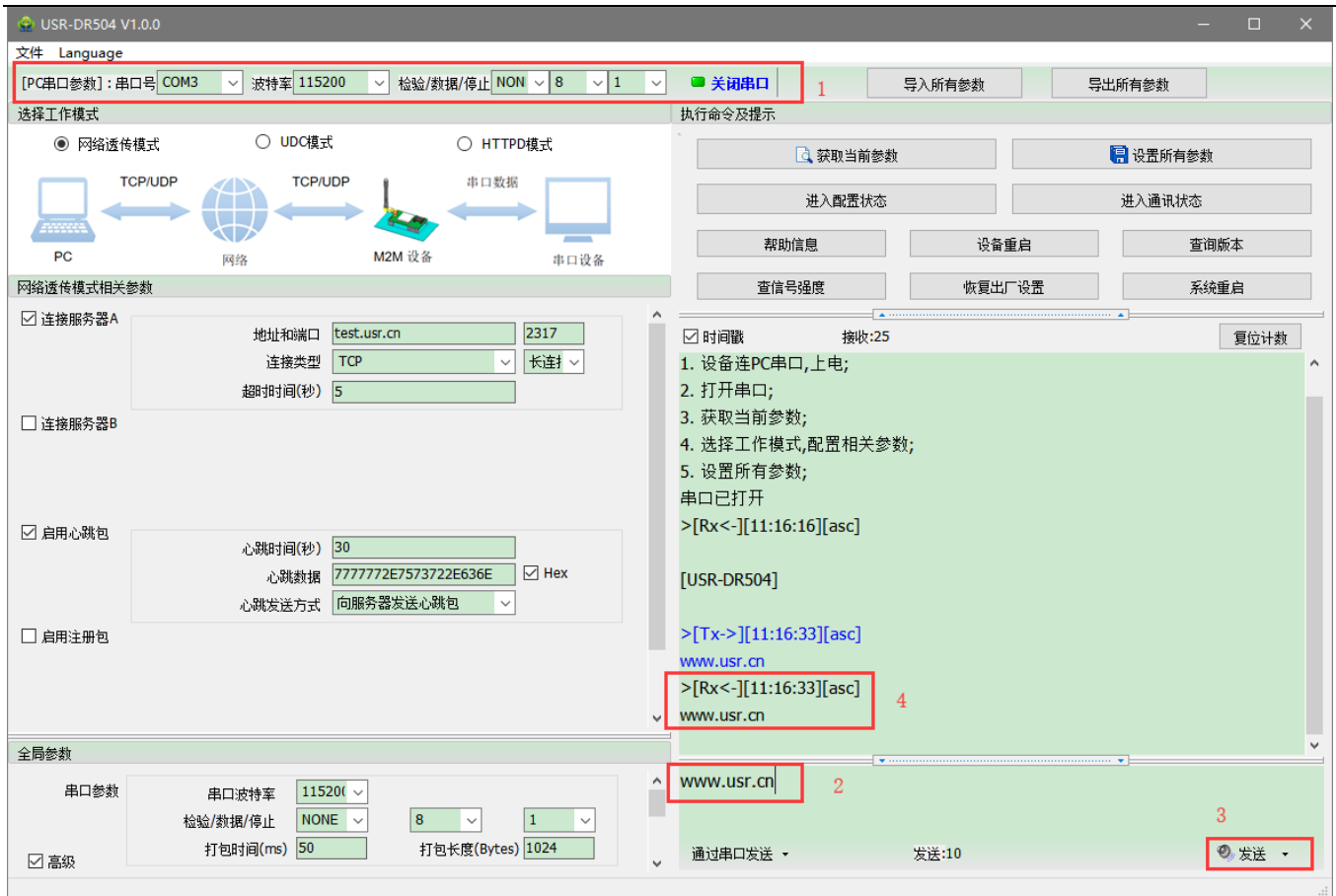
图 3 设置软件示意图
