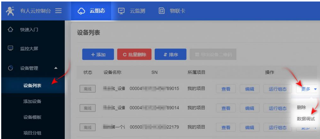
图 7 打开有人云数据调试窗口示意图
